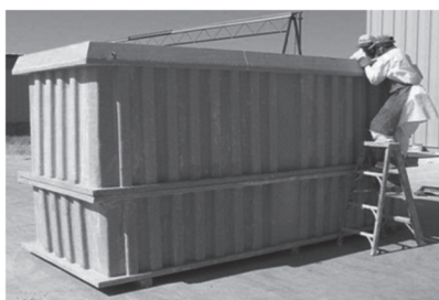
Obudowa stacji transformatorowej Housing of transformer station
